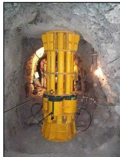
**Figure 2-13.** Plate jacking test (Rezaei et al, 2016).
